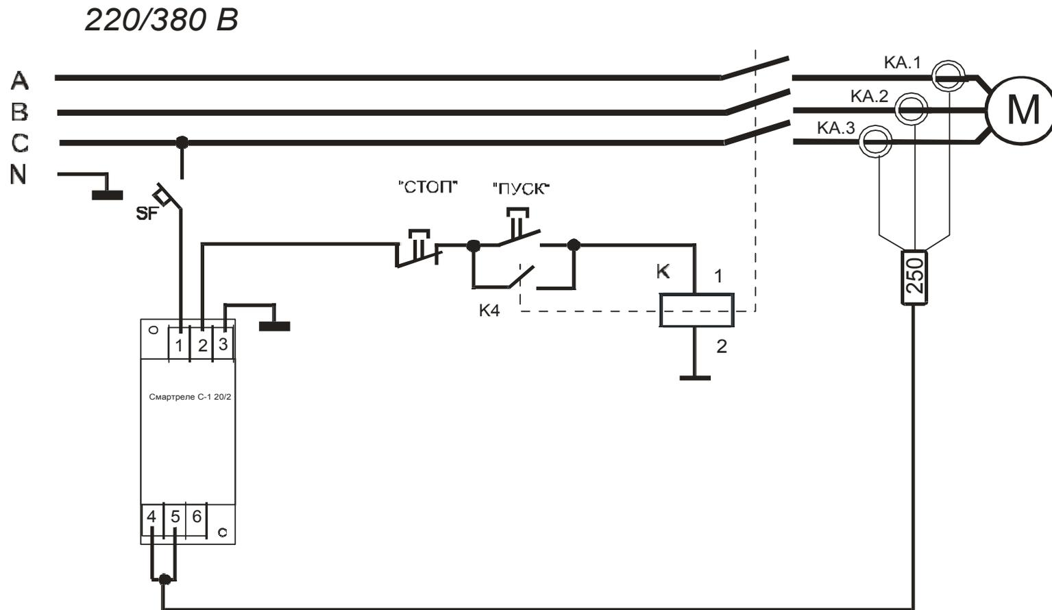
Рисунок 5 - схема включения СМАРТРЕЛЕ С-120/2, С-120/3 в систему управления электродвигател
