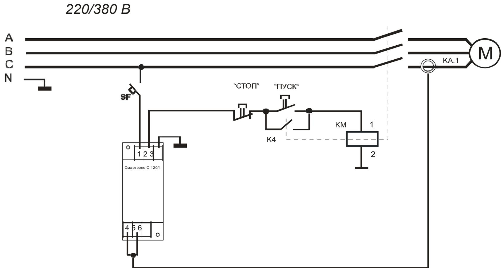
Рисунок 4 - схема включения СМАРТРЕЛЕ С-120/1 в систему управления электродвигателем М
