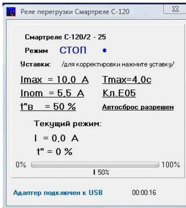
Рисунок 8, а – отображение настроек реле на экране ПК
